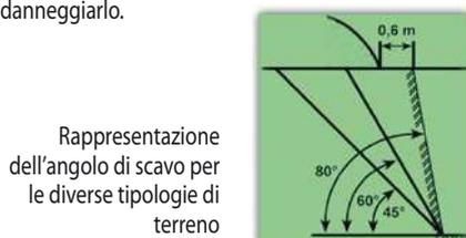
Rappresentazione dell'angolo di scavo per le diverse tipologie di terreno
