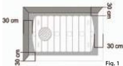
2. Creare un letto di 15-20 cm di sabbia non riciclata, disponendo al suo interno almeno un tubo di drenaggio. Livellare accuratamente la base così realizzata, avendo cura di eliminare ogni eventuale asperità. Accertarsi che la zona di appoggio non ceda sotto il peso del serbatoio pieno.
